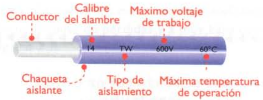
Figura 3.1. Estructura básica del alambre
