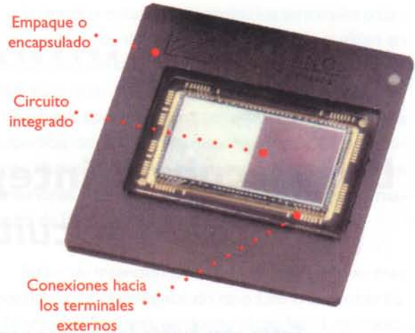
Figura 13.2. Estructura general de un circuito integrado
