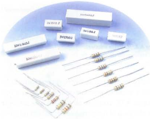
Figura 6.4. Resistencias para montaje por inserción
