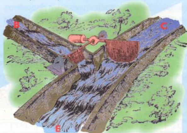
Figura 10.7c. En este caso hay una corriente de agua un poco mayor en el canal regulador (B). La compuerta principal se abre más y deja circular una mayor cantidad de agua entre los puntos C y E.
