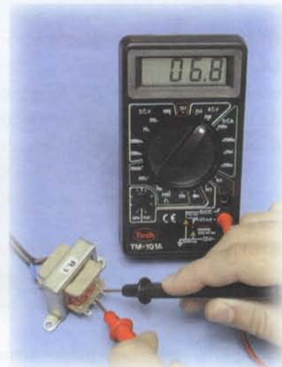
Figura 8.26. Prueba del voltaje de CA en el secundario de un transformador
