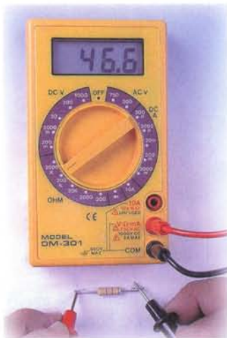
Figura 6.9. Prueba de las resistencias con el multímetro
