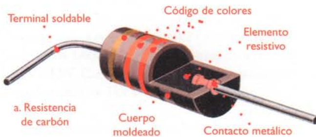
Figura 6.3. Estructura interna de las resistencias fijas
