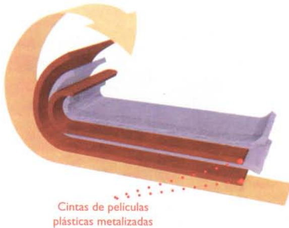
Figura 7.7. Estructura interna típica de los condensadores de película plástica
