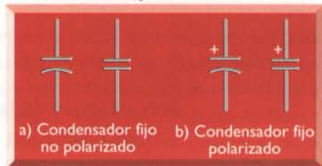
Figura 7.3. Símbolos de los condensadores fijos
