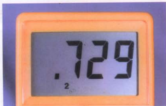
Figura 9.33. Prueba de un diodo con un multímetro digital
