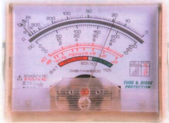
Figura 10.10. Prueba de un transistor NPN. Con la perilla selectora ubicada en la posición Rx1, o en la más baja disponible, coloque la punta de prueba negativa (negra) en la base del transistor (terminal central visto de frente) y la punta positiva (roja) en el emisor (terminal de la izquierda); en este momento la aguja debe mostrar una resistencia baja. Pase ahora la punta roja al colector (terminal derecho), la aguja debe mostrar una medida similar. Coloque ahora la punta roja en la base y toque con la punta negra el emisor y el colector. No debe mostrar ningún valor.
