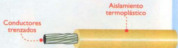
Figura 3.2. Estructura básica del cable trenzado
