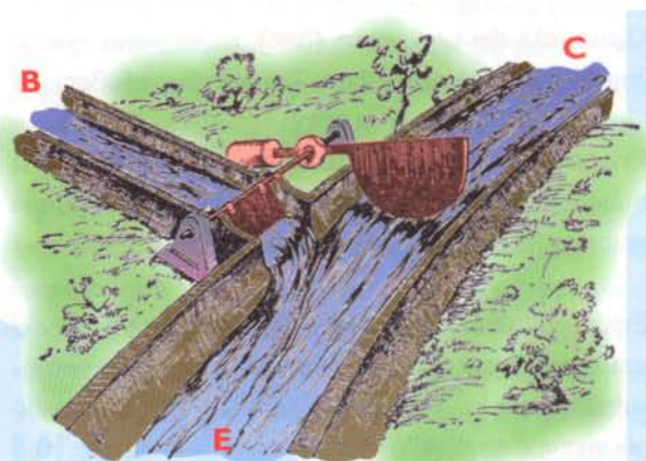
Figura 10.7b. En este caso hay una débil corriente de agua en el canal regulador (B), por su efecto, la compuerta principal se abre un poco y deja circular una buena cantidad de agua entre los puntos C y E.
